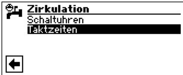
Unter dem Punkt Taktzeiten kann entschieden werden, für welche Zeit die Pumpe innerhalb der freigegebenen Zeitperioden ein- oder ausgeschaltet ist.
